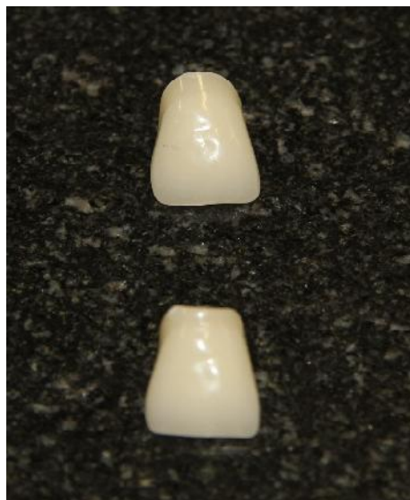
Figura 6. Borda amassada que não resultou em perda de massa.
