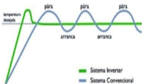
Figura 5. Comparação do sistema *inverter* x convencional. Fonte: NEWTEMP (2014)<sup>11</sup>.
