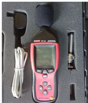
**Figura 1.** Medidor de Nível de Pressão Sonora (MNPS). Foto: da autora.
