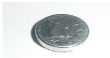
**Figura 8.** Ímã neodímio-ferro-boro ( $\varnothing = 14 \text{ mm}$  e  $L = 4 \text{ mm}$ ). **Fonte:** Autores
