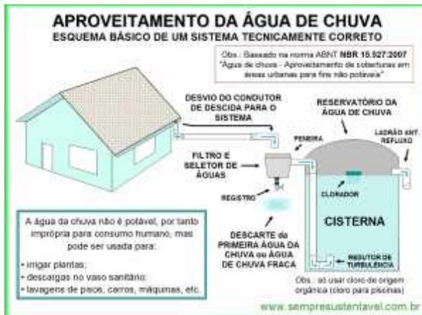
**Figura 5.** Captação de água de chuva de acordo com a ABNT/NBR<sup>20</sup> 15.527/2007. Fonte: Aproveitamento de água de chuva de baixo custo para residências urbanas<sup>22</sup>.
