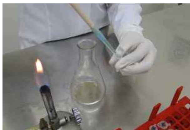
Figura 2. Depositando através de um pipetador o caldo de Infusão de Cérebro e Coração (BHI, Merck), estéril, nos eppendorfs onde os cones serão imersos e incubados para verificação de turbidez.
